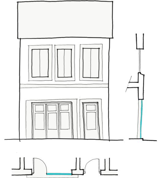
Pour une devanture en feuillure, une continuité visuelle avec les étages est préférable en optant pour un seul matériau pour le bâtiment. La qualité du matériau utilisé pour la devanture doit être choisie en rapport avec l'architecture de la façade de l'immeuble.
